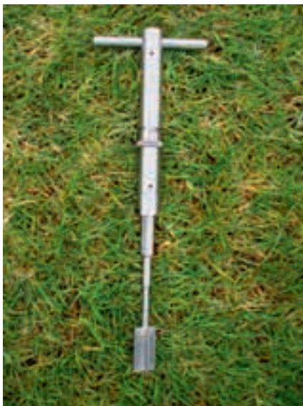
Foto 1: Flügelsonde zur Bestimmung der Scherfestigkeit eines Rasentragschichtgemischs (Foto: Nonn).
