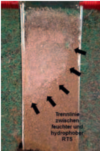
Abb. 1: LDS in einer Rasentragschicht eines Grüns. Scharf abgegrenzte Linie zwischen feuchtem (rechts) und hydrophobem (links) Bereich. (Quelle: Lung)
