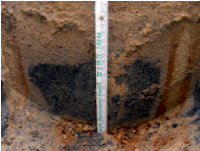
Foto 1: Grün 5; Ausgangssituation am 10.6.2009; deutlich sichtbar sind die dunkle Black-Layer-Zone und die Eisenoxidausfällung in der Wandung der Bohrlöcher aus dem Jahre 2002 sowie die Kolmationsschicht im Übergang von Rasentragschicht zu Dränschicht.
