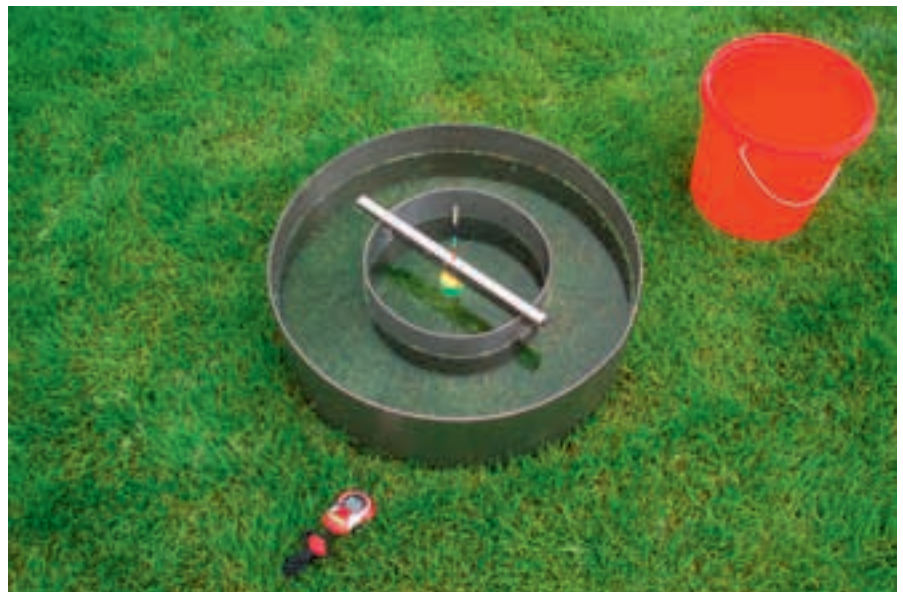
Foto 2: Doppelring-Infiltrometer zur Bestimmung der Wasserinfiltrationsrate eines Rasensportplatzes (Foto: Nonn).
